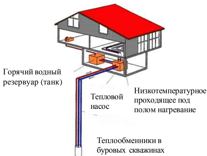
Рисунок - Типичное применение домашней системы теплоснабжения с геотермальным тепловым насосом в Центральной Европе (глубина скважин около 100 м)
